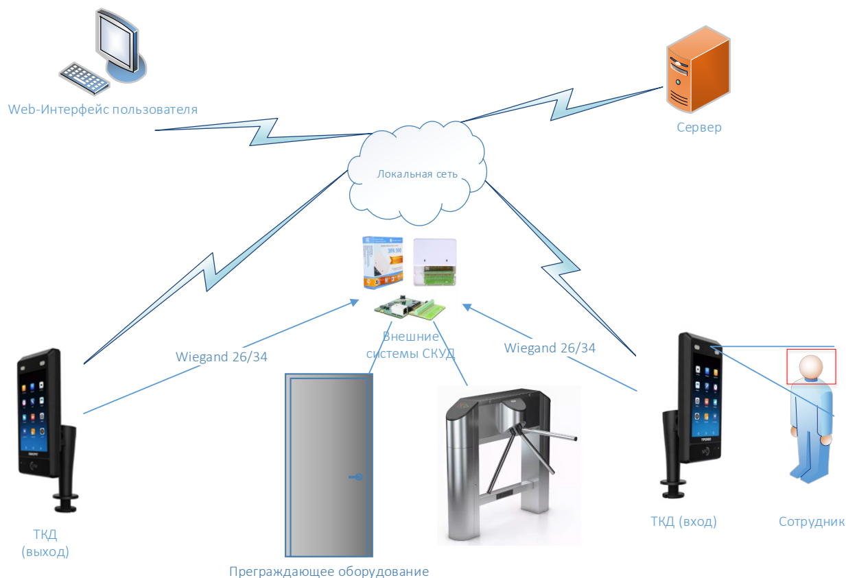
Рис.9 Схема подключения к существующей СКУД
